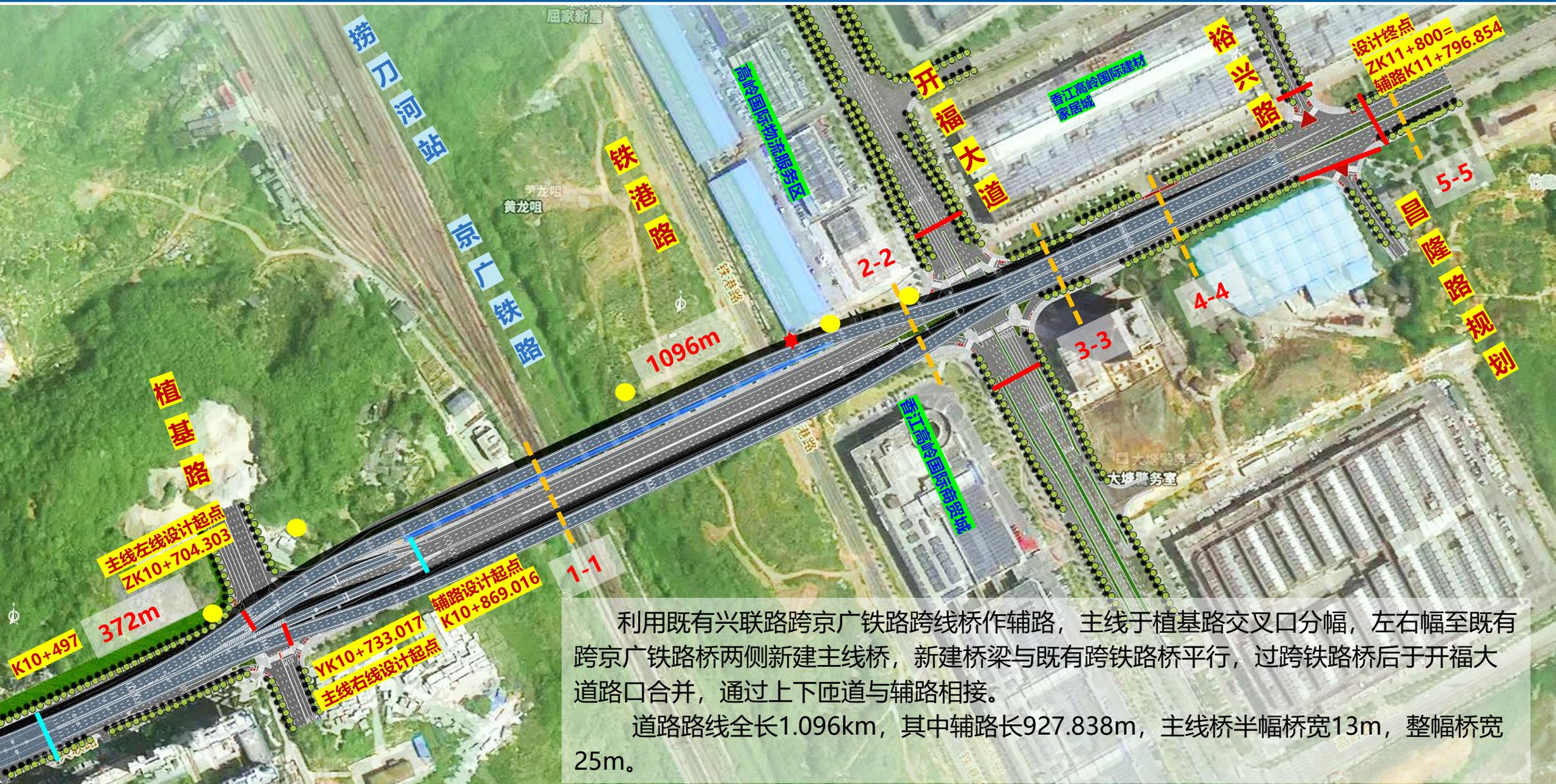
利用既有兴联路跨京广铁路跨线桥作辅路，主线于植基路交叉口分幅，左右幅至既有跨京广铁路桥两侧新建主线桥，新建桥梁与既有跨铁路桥平行，过跨铁路桥后于开福大道路口合并，通过上下匝道与辅路相接。
